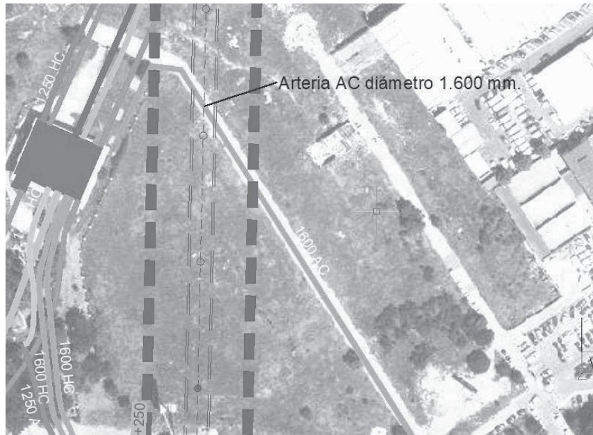
Figura 10: Interferencia del trazado de Metro con arteria a retranquear en las obras del Nudo Norte
