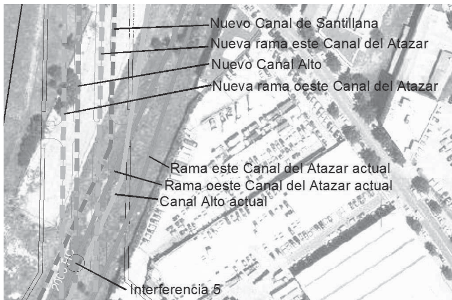
Figura 5: Interferencia 5 en la conexión final del retranqueo del Canal Alto y el Canal del Atazar en el entorno del nudo de la Malmea
